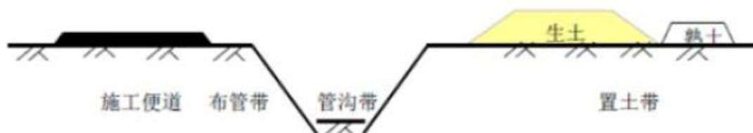
图 3.3-2 管道施工平面布置图
